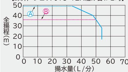
▲吸上高さ12m、運転圧力:「高」(OFF圧力 370kPa)
