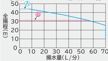
▲吸上高さ7m、運転圧力:「高」(OFF圧力 370kPa)
