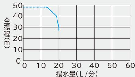
吸上高さ24m、運転圧力:「標準」(OFF圧力240kPa)
