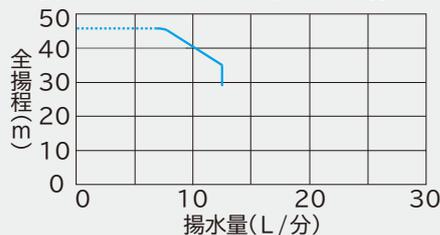
吸上高さ24m、運転圧力:「標準」(OFF圧力 220kPa)
