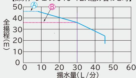
A 吸上高さ12m、運転圧力:「高」(OFF圧力 340kPa)
