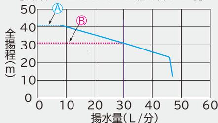
A 吸上高さ7m、運転圧力:「高」(OFF圧力 340kPa)
