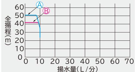
吸上高さ24m (A) 運転圧力: 「標準」(制御圧力270kPa)
