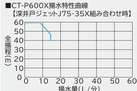
吸上高さ35m、運転圧力:「標準」(OFF圧力240kPa)
